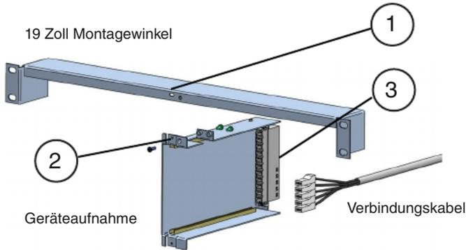
**Schritt 1:** Verschrauben Sie den 19 Zoll Montagewinkel mit Hilfe der mitgelieferten Schraube mit der Geräteaufnahme. Das Bohrloch [1] und die Aussparung [2] an der Geräteaufnahme müssen dabei übereinander liegen.
